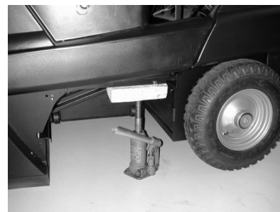
Точка установки домкрата (задние колеса)
