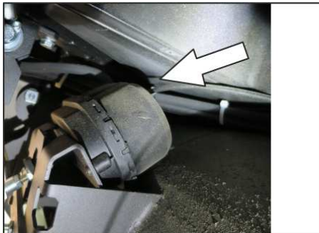
Schlauchanschluss zur Unterdruckdose der Seitenbesenabsenkung
