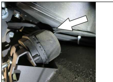
Sļūteņu pieslēgšana sānu slotu nolaišanas mehānisma vakuuma kārbai
