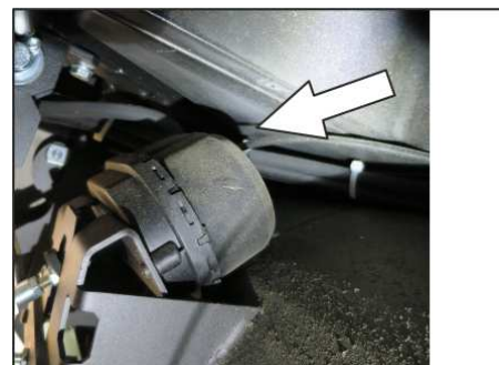
Slangetilkobling for undertrykkslange for senking av sidebørster
