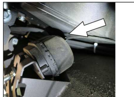
Slanganslutning till undertrycksdosor för sänkning av sidoborstar.
