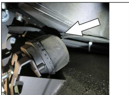
Raccordo del tubo flessibile della camera di sottopressione del dispositivo di abbassamento delle spazzole laterali
