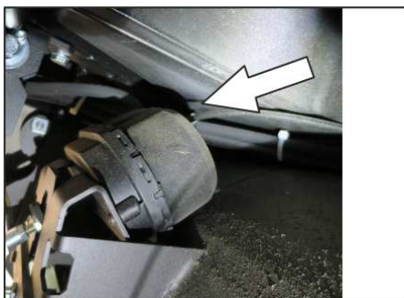
Raccord de flexible vers la boîte de dépression de l'abaissement des balais latéraux
