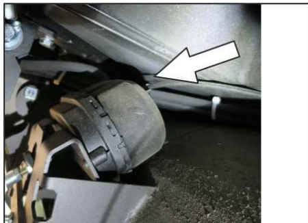
Tömlőcsatlakozás az oldalkefe leengedés vákuummérő szelencéjéhez
