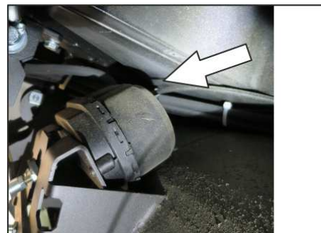
Priključek gibke cevi do podtlačne doze spuščanja stranskega omela
