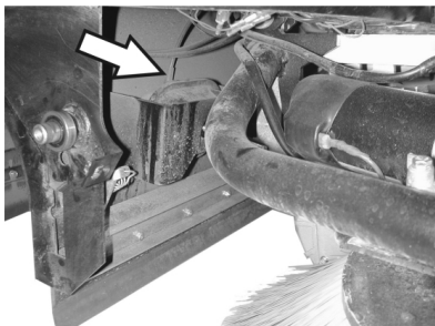
Slanganslutning till undertrycksdosa för sänkning av sidoborstar.
