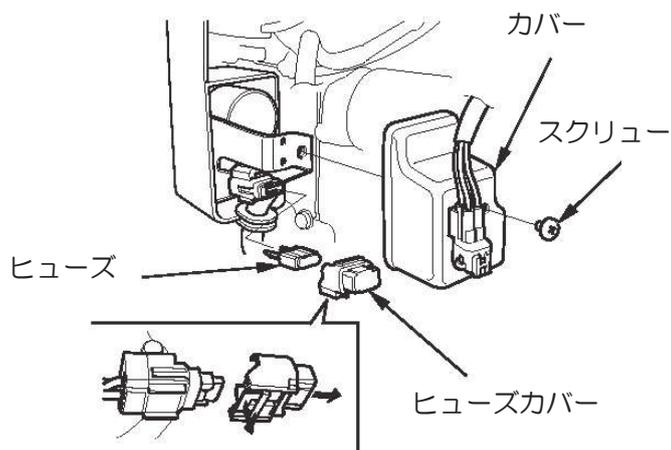
カバー固定スクリューを取り外してください。ヒューズカバーを取り外してください。ヒューズを引き抜きヒューズを確認をしてください。
