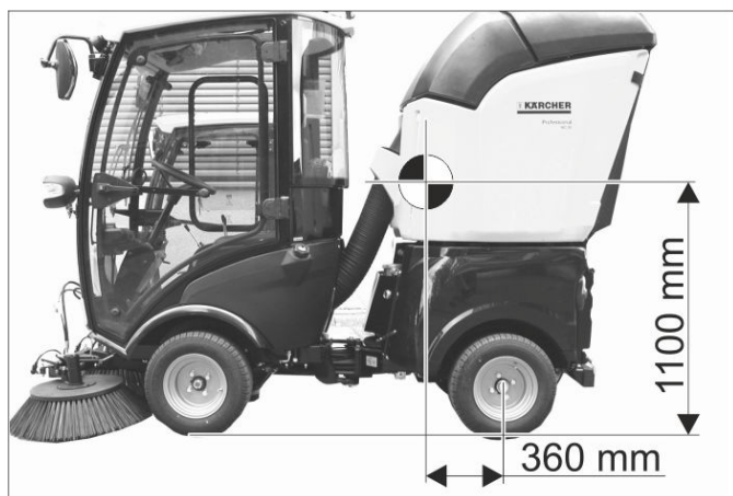
Tyngdepunkt ved lastet apparat.
