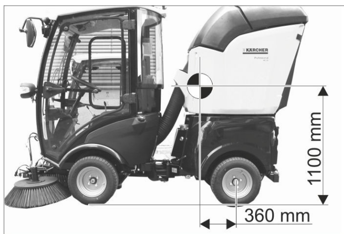
Tyngdepunktet ved fuld læsset maskine.
