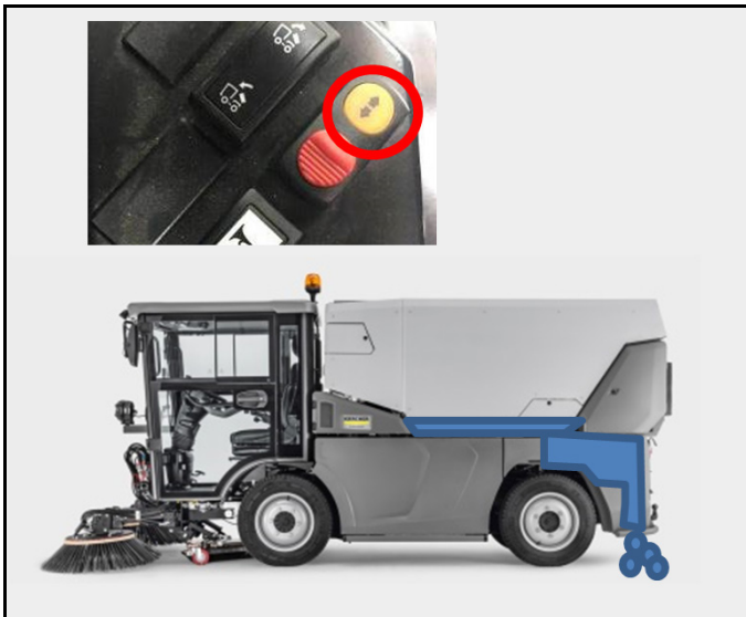
Figure : Vidangez l'eau sale / l'eau de recyclage
