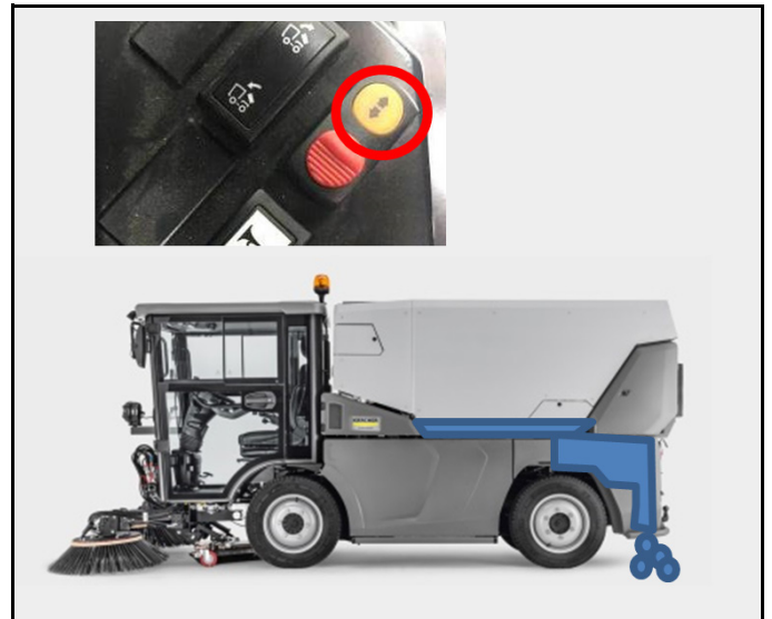
Figura: Drenar el agua sucia/agua reciclada
