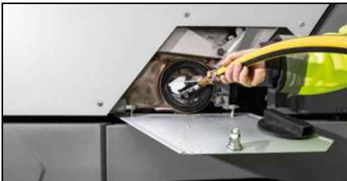
Afbeelding: Reiniging recyclingsysteem
