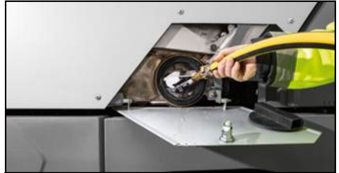
Figura: Limpieza del sistema de reciclaje
